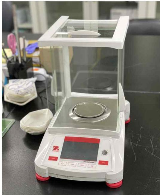
그림3-1. 천립중 측정실험 및 전자저울 사진
