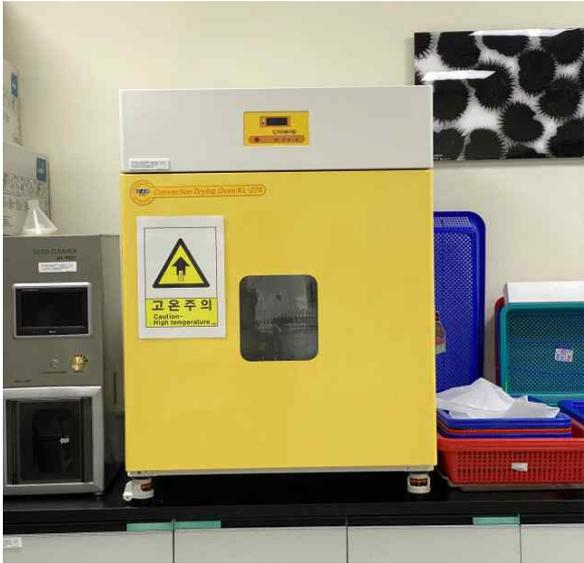
그림3-3. 수분함량 측정실험 및 항온건조기 사진
