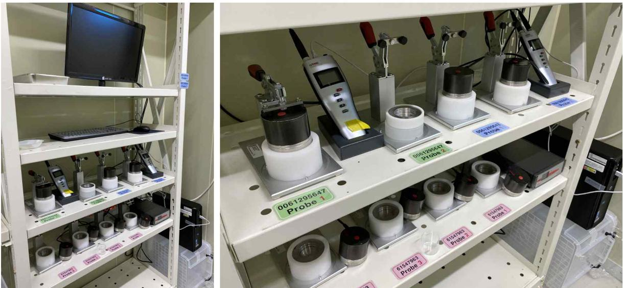
그림3-2. 평형상대습도 측정실험 및 Hygrometer 사진
